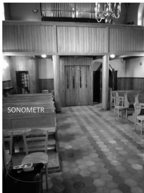
Fot.4. Ustawienie sonometru podczas pomiaru w kościele pw. NMP w Dobranowicach. (źródło: opracowanie własne)
