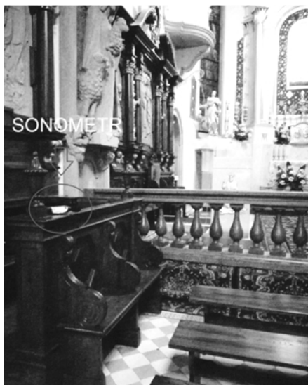
Fot.3. Ustawienie sonometru podczas pomiaru w Bazylice Matki Boskiej Bolesnej w Limanowej (źródło: opracowanie własne) Photo.3. Positioning of the sound level meter during the measurement at the Basilica of Our Lady of Sorrows in Limanowa (source: own elaboration)
