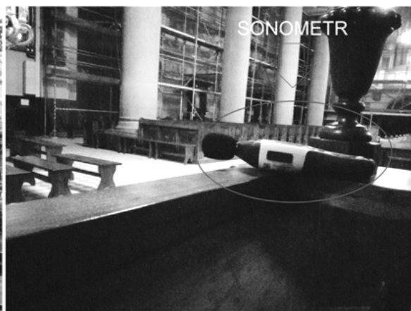
Fot.3. Ustawienie sonometru podczas pomiaru w Bazylice Matki Boskiej Bolesnej w Limanowej (źródło: opracowanie własne) Photo.3. Positioning of the sound level meter during the measurement at the Basilica of Our Lady of Sorrows in Limanowa (source: own elaboration)
