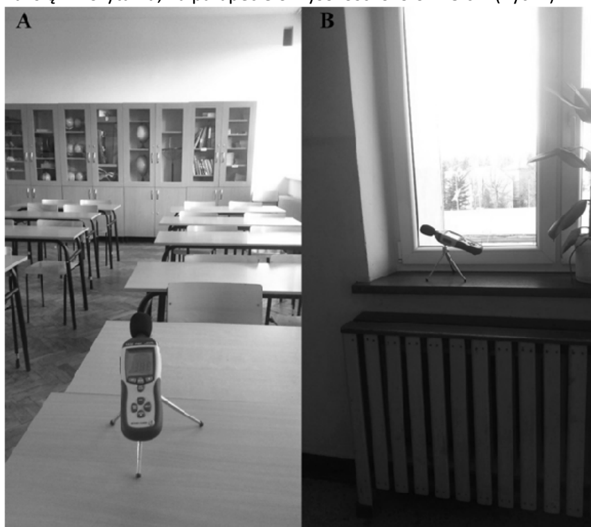
Fot.1. Umieszczenie sonometru podczas przeprowadzania pomiarów – A w klasie – B na korytarzu. (źródło: opracowanie własne)
