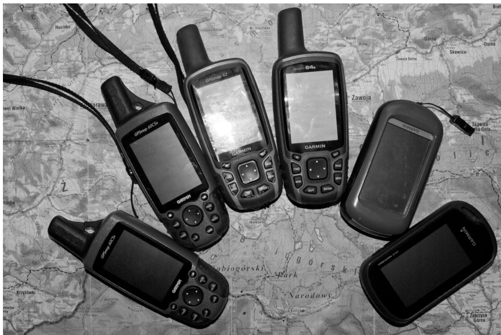
Fot.1. Odbiorniki GPS używane przez uczestników pomiaru. Od lewej: Garmin GPSMap 60CSx (2 sztuki), GPSMap 62, GPSMap 64, (zapisujące inne obiekty podczas pomiaru) Oregon 300, Oregon 500. (źródło: opracowanie własne)
